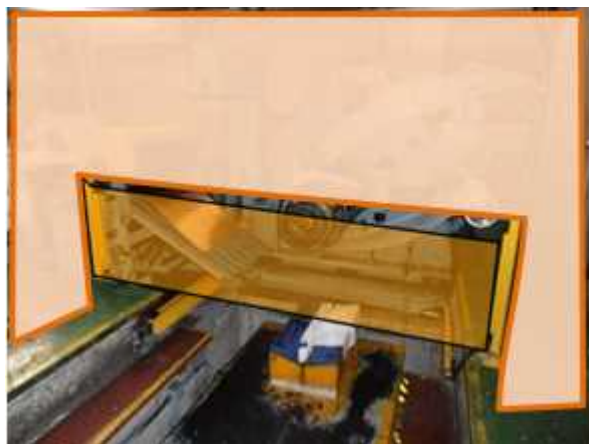
図 189 安全柵の設置スペースがない場所に人感センサー（ライトカーテン）を設置した事例
