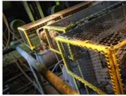
図 186 回転体に安全カバーを設置した事例（2）
