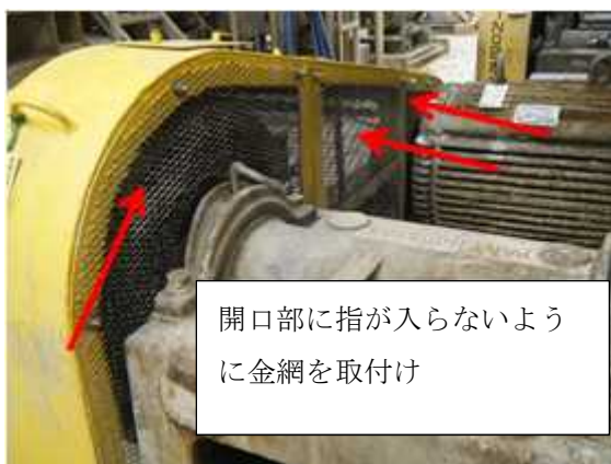
図 185 回転体に安全カバーを設置した事例 (1)
