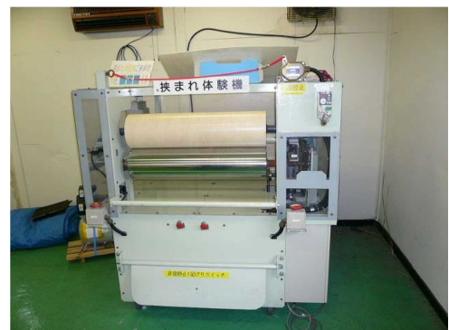
図 204 センサー、安全装置を装備した「はさまれ、巻き込まれ」体験機
