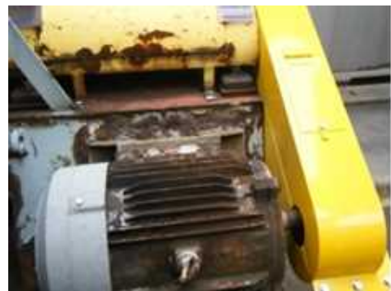
図 185 回転体に安全カバーを設置した事例 (1)
